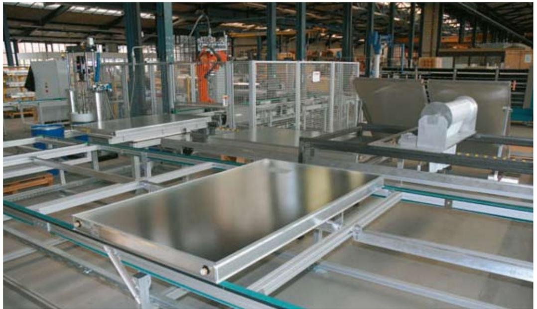
Die neue Produktionslinie für den Flachdachkollektor FK2
