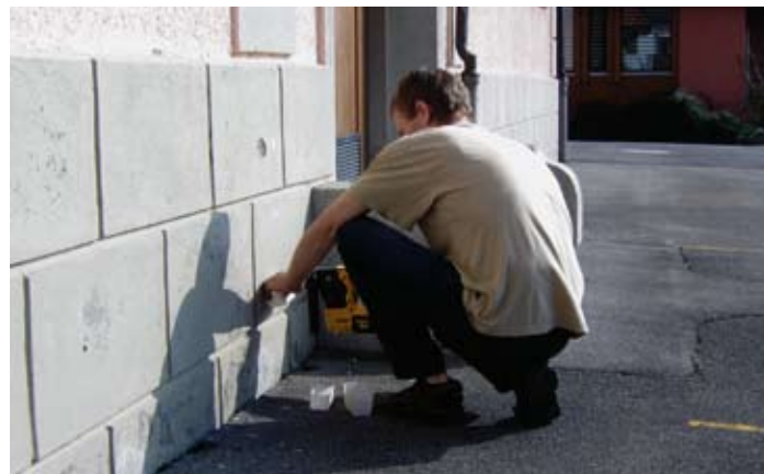
Bohrmehl-Analyse mit mobilem Laborgerät
