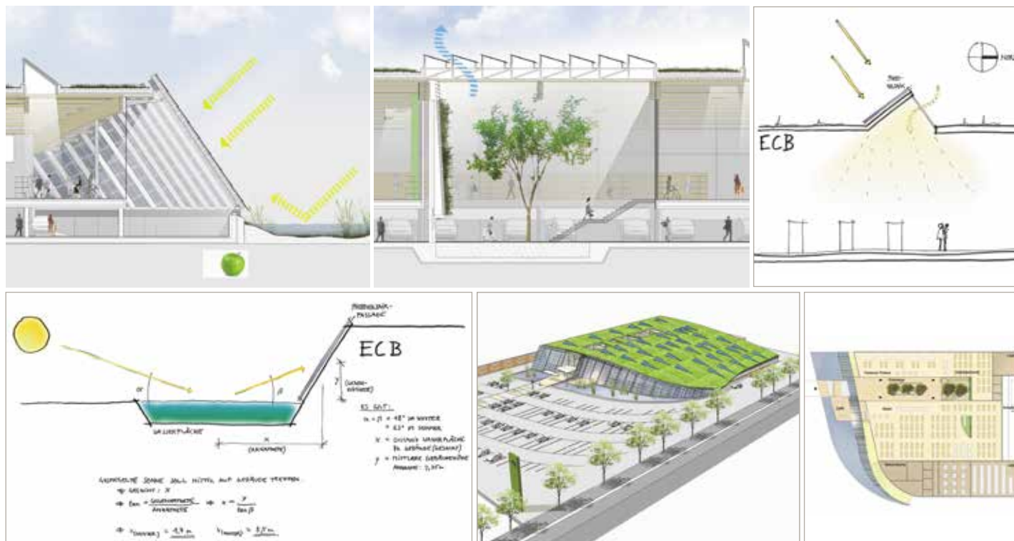
Links oben: Durch die Reflektion der Sonneneinstrahlung auf dem vorgelagerten Wassergürtel wird die Effizienz der Photovoltaikanlage auf der Eingangsfront noch erhöht. Mitte oben: Im Inneren des Supermarktes sorgen Dachfenster gegen Norden für eine gleichmässige Belichtung ohne direkte Sonneneinstrahlung. Rechts oben: Durch die Nutzung von Tageslicht lässt sich der Energiebedarf für die Beleuchtung um 25% reduzieren. Die gegen Norden ausgerichteten Shedflächen reduzieren die Kühllast. Die Rückseite dient zur Gewinnung von Solarenergie mittels Photovoltaikmodulen. Links unten: Entscheidend für den Wirkungsgrad der Photovoltaikanlage sind die Ausrichtung und die Neigung der Aufstellflächen.
