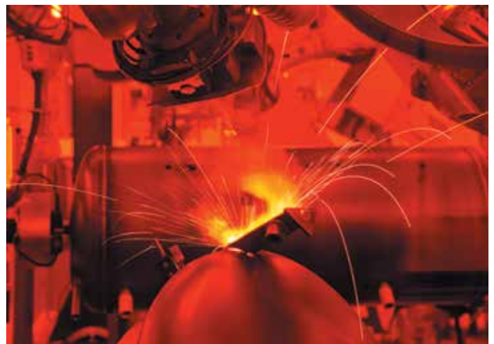
Der Schweißroboter bei der Arbeit
