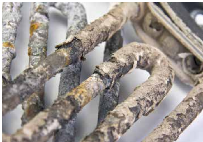
Bereits 1 mm Kalkbelag bedeutet 10% mehr Energieverbrauch bei der Wassererwärmung. Ein KalkMaster-Abo verhindert dies nachhaltig.
