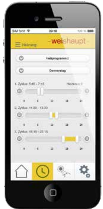
Einstellung der Zeitprogramme Einstellung Zeitprogramm für mehrere Heizkreise und Heizzyklen.
