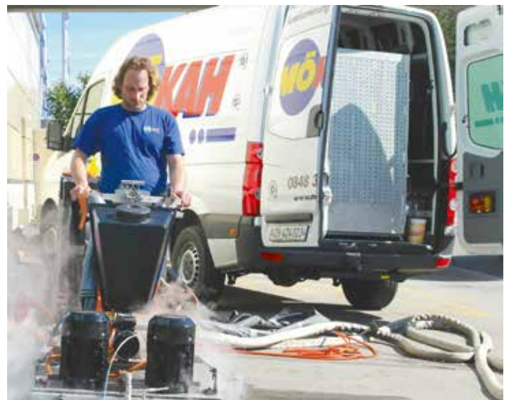
PowerCleaner: mit thermo-mechanischer Technologie gegen Kaugummi-Flecken & Co.
