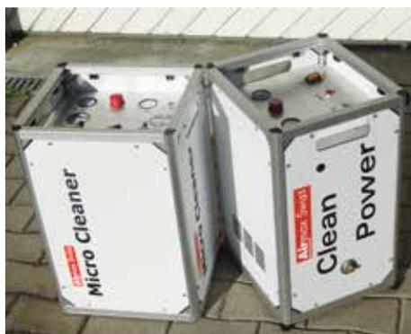
Das «Microclean»- System reinigt effizient Bodenheizungsrohre.
