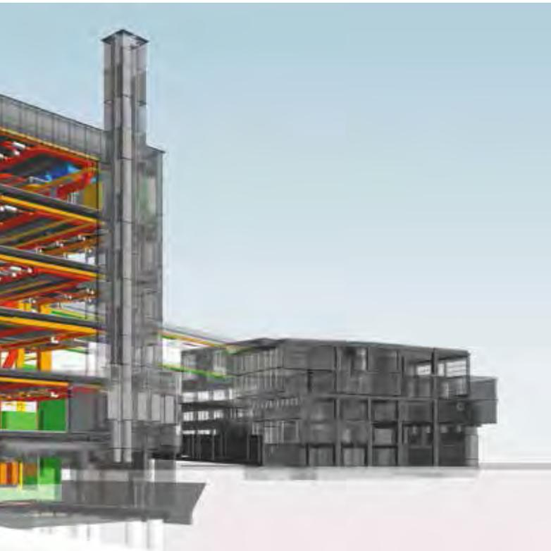
**ABB. 2: 3D-Bauteil mit mehrschichtigen Informationen**
