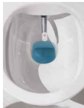
Der Duschstab ist im Ruhezustand hinter einem Blendenring in der Keramik verborgen. Er wird vor und nach jeder Nutzung durchgespült, mit einem kräftigen Wasserstrahl umspült und damit gereinigt. Der Wasserstrahl ist in sieben Stufen regelbar. Bei der Lady-Funktion passt sich die Strahlposition mit reduziertem Wasservolumen und weicherer Strahlstärke an. Foto: Keramik Laufen
