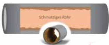
Nach langjährigem Betrieb lagern sich Schlamm und sonstige Schmutzpartikel in den Rohren ab.
