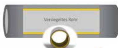
... zu schliessen, werden die Heizungsrohre durch ein Versiegelungsverfahren von innen versiegelt.
