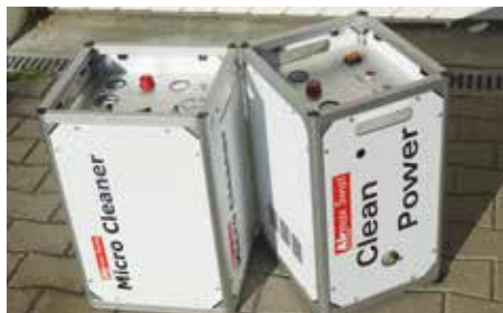
Das «Microclean»- System reinigt effizient Bodenheizungsrohre.
