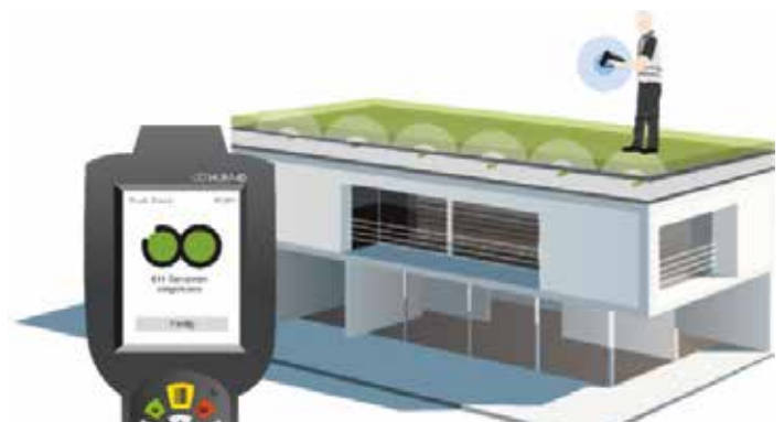
Einfaches Aktivieren und Auslesen der Dachkontroll-Sensoren
