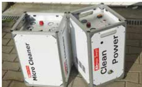
Das «Microclean»- System reinigt effizient Bodenheizungsrohre.
