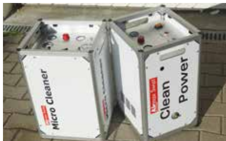
Das «Microclean»-System reinigt effizient Bodenheizungsrohre.
