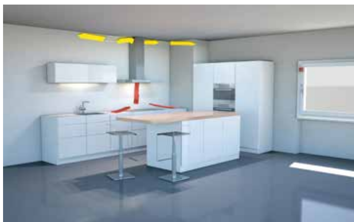
Dunstabzugshaube im Umluftbetrieb (Fenster geschlossen) mit WESCO autoSwitch
