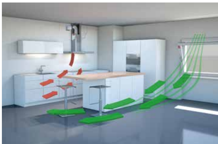
Dunstabzugshaube im Abluftbetrieb (Fenster geöffnet) mit WESCO autoSwitch
