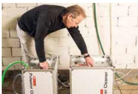
Das «Microclean»- System reinigt effizient Bodenheizungsrohre.
