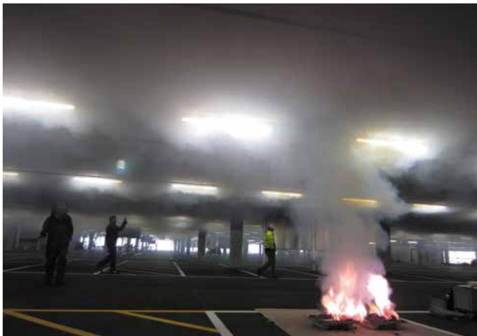
Ein Test der Entrauchungsanlage in einem Parkgebäude (Bild: Swiss Safety Center).
