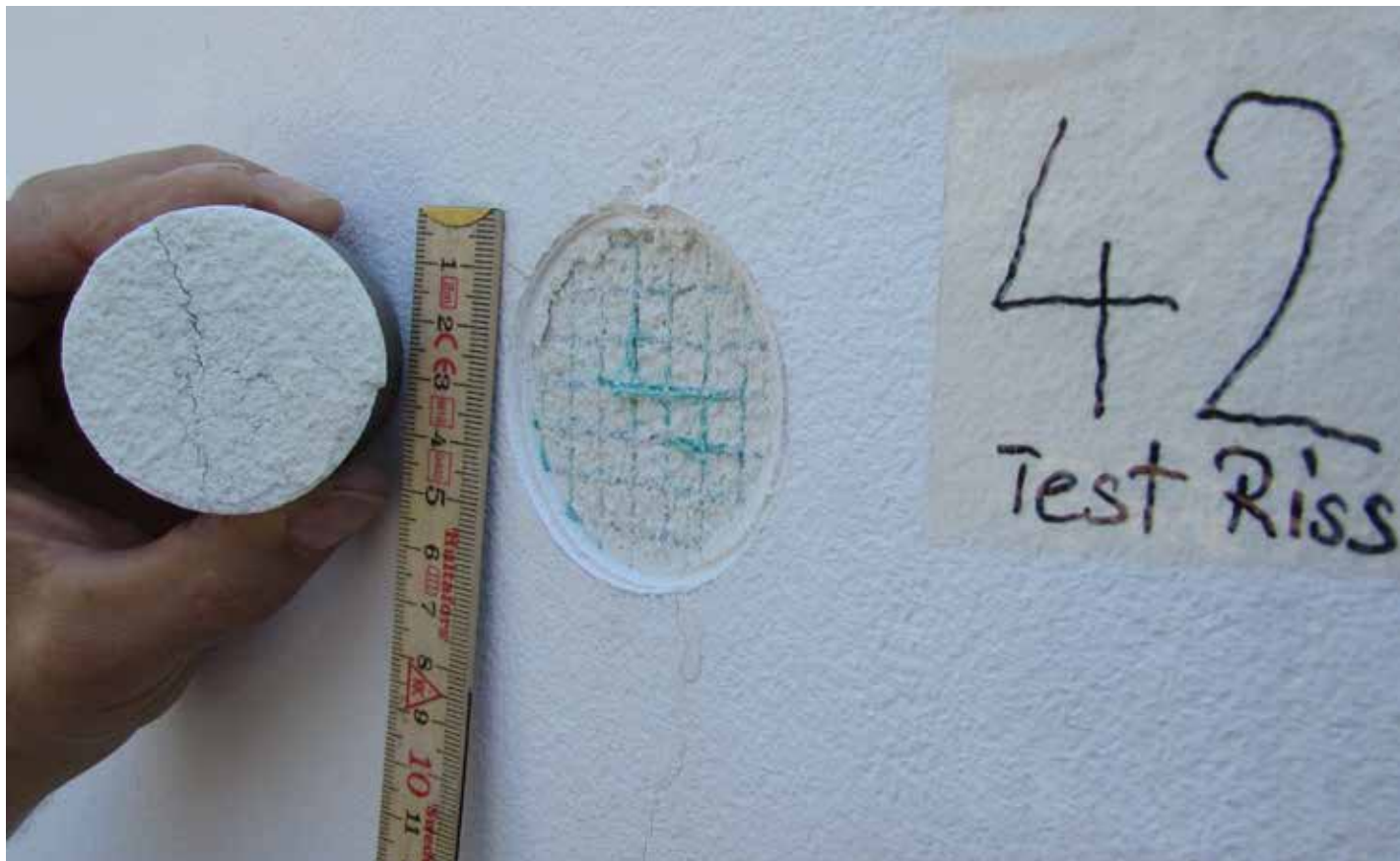
Mit der Entnahme einer Probe prüft der Fachexperte die Qualität des Verputzes (Bild: SMGV).
