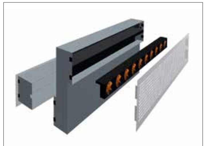
Die Konstruktion Leistungsaufnahme der langsam drehenden Ventilatoren bei 60 m 3 / insgesamt nur 3,3 W. Werkzeuglose Demontage der Frontplatte, Reinigung vom Raum aus möglich. Einfacher Austausch der Lüfter oder des Transformators.
