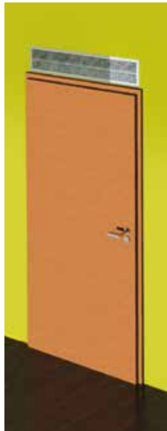
Die Konstruktion Leistungsaufnahme der langsam drehenden Ventilatoren bei 60 m 3 / insgesamt nur 3,3 W. Werkzeuglose Demontage der Frontplatte, Reinigung vom Raum aus möglich. Einfacher Austausch der Lüfter oder des Transformators.
