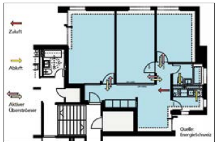
Das Schema zeigt ein optimales Lüftungs-Konzept: - Zuluft einbringung im Korridor - Abluft über WC und Küche - Be-/Entlüftung der Räume bei geschlossener Tür durch «Aktive Überströmer» - Einbau in der Wand über der Türe
