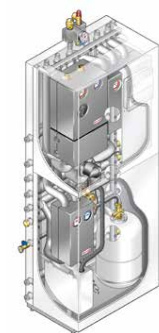
Schnittgrafik des neuen Weishaupt Installations-Towers WIT.
