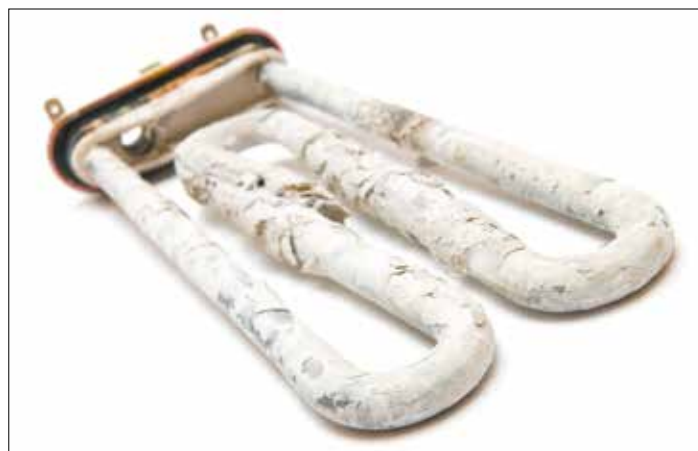
Bereits 1 mm Kalkbelag bedeutet 10% mehr Energieverbrauch bei der Wassererwärmung. Ein «KalkMaster Abo» reduziert die Energiekosten nachhaltig.
