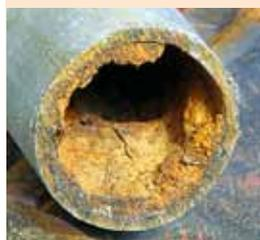
Derart verrostete Rohre sind keine Seltenheit. Die dicke Rostschicht bewirkt eine Rohrverengung und einen damit verbundenen Druckabfall sowie Rostwasser. Höchste Zeit für eine Sanierung!
