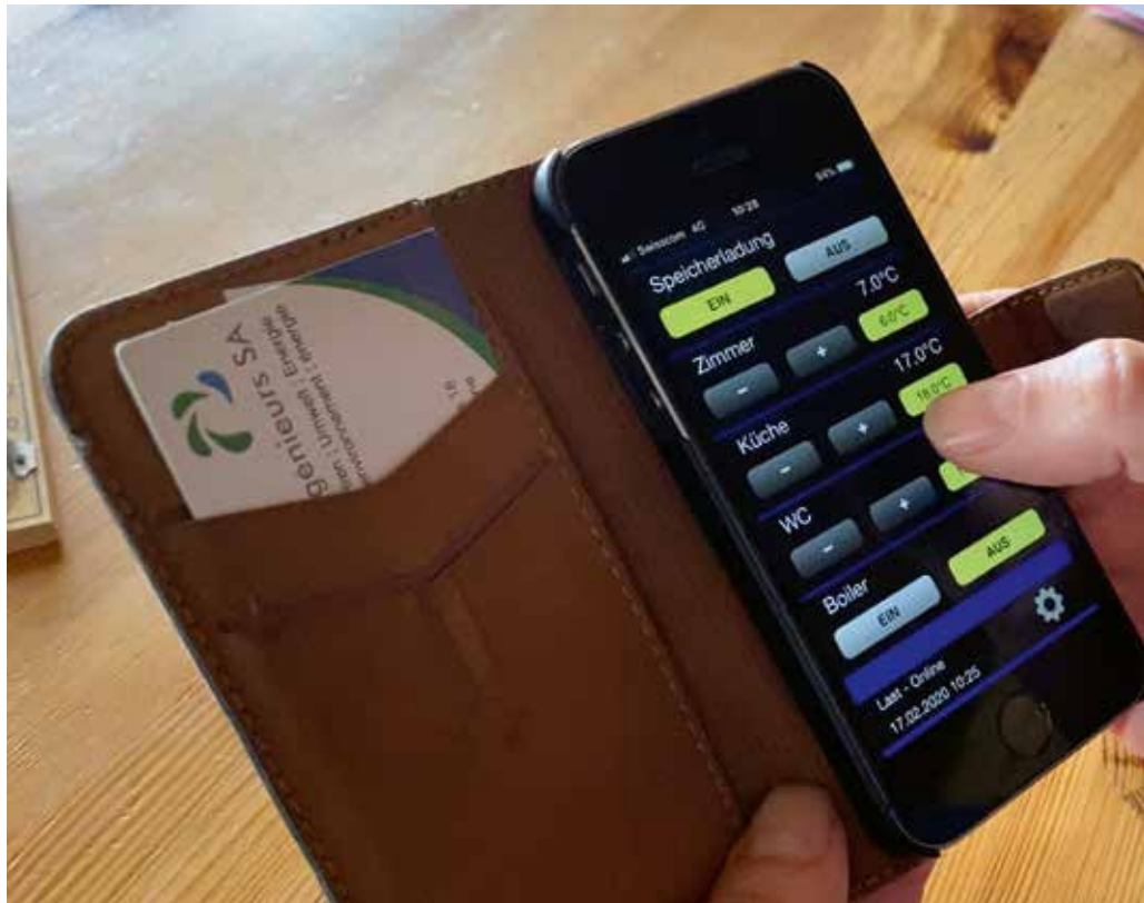
Mit einer Fernbedienung kann die Heizung von überall und jederzeit bedient werden. Je nach Anwendung lässt sich sogar die Temperatur einzelner Räume steuern. BILD: ENERGIESCHWEIZ
